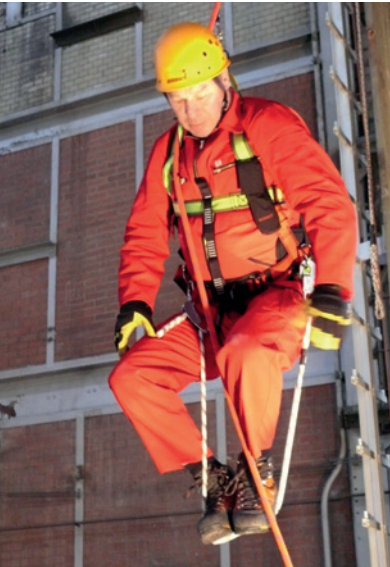
Halteseil mit Längeneinstellvorrichtung
